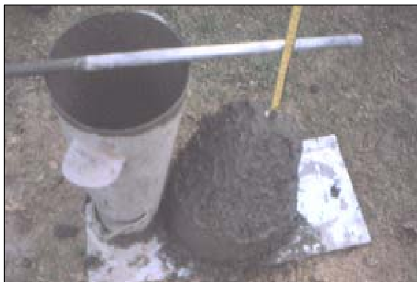
Figura 20. Ensayo de asentamiento de concreto.
