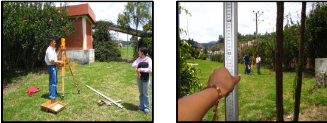
Figura 37. Nivelación entrada principal peatonal.
