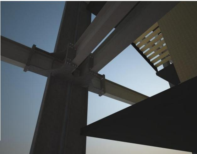
Figura n. 279 Imágenes Conexiones Estructura Centro Cultural
