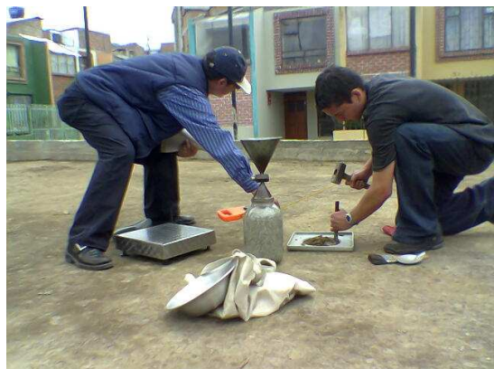
Figura 33 Ensayo de cono y arena para la determinación de la densidad de la base en recebo
