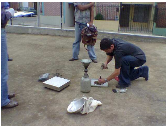
Figura 33 Ensayo de cono y arena para la determinación de la densidad de la base en recebo
