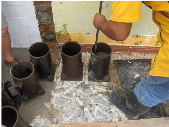
**Foto: 36 Moldes o cilindros metálicos.**
