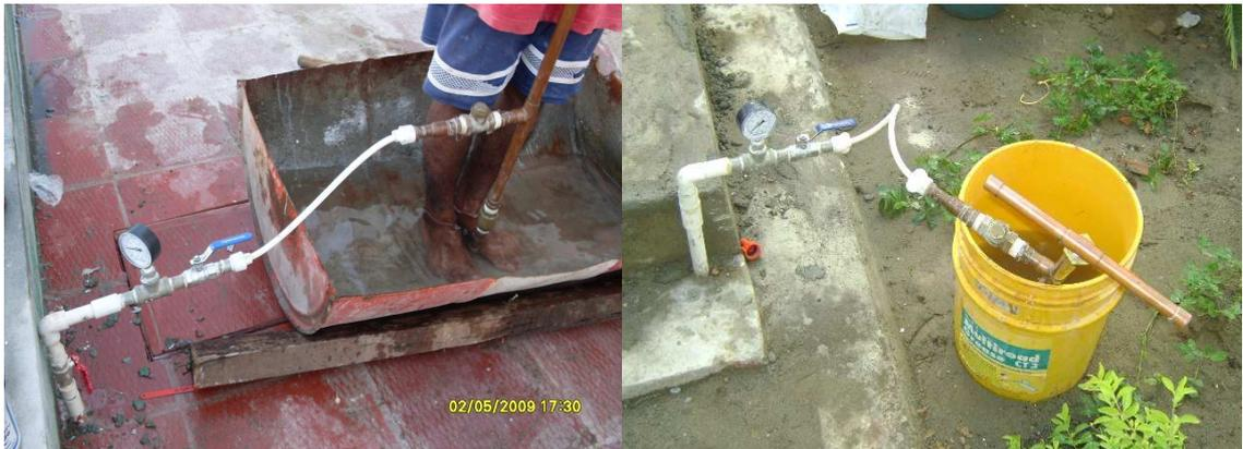
Foto: 39(1) y (2) Ensayo de presión en red de abastos.
