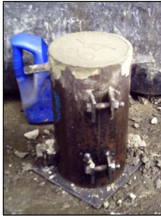
FIGURA 64.- TOMA DE CILINDROS
