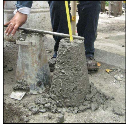
FIGURA 65.- ENSAYO DE ASENTAMIENTO
