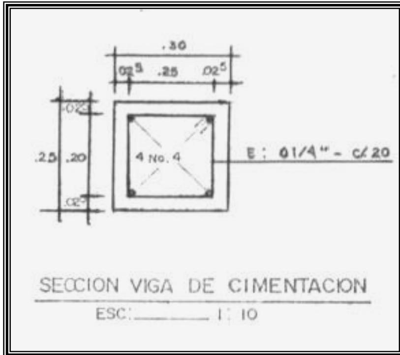
Figura 49. Diseño viga de cimentación
