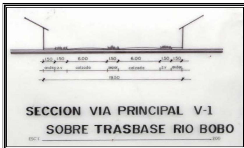
Figura 36. Diseño vía vehicular principal
