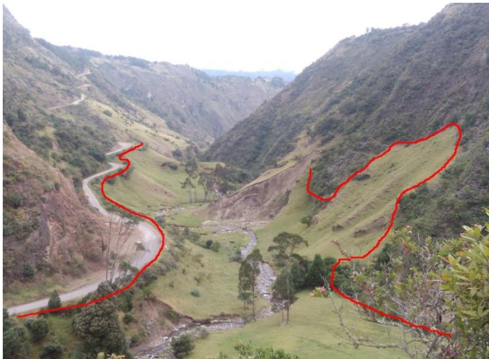
Figura 33. Depósito coluvio-aluvial (línea roja) ubicado en la quebrada Caicuanes, parte baja de la microcuenca.
