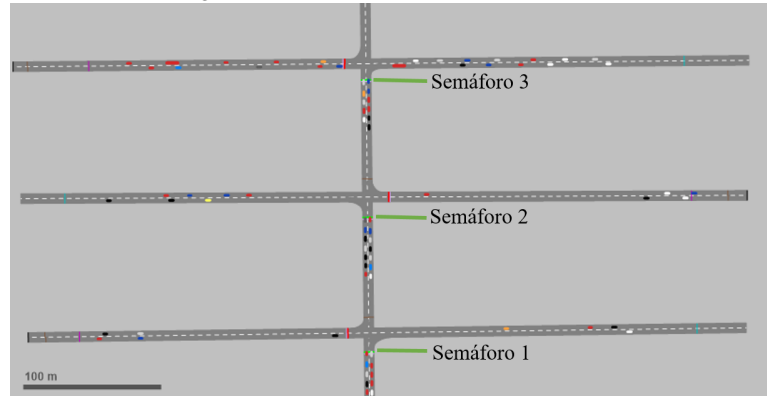
Figura 15. Red de tráfico con tres intersecciones interconectadas por un carril con dirección de flujo vehicular Sur-Norte.
