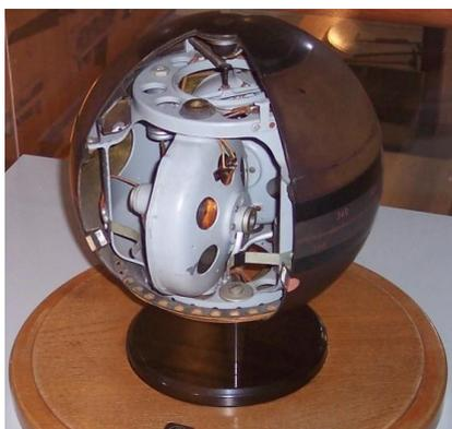
Fig. 4.51. Brújula giroscópica. Fuente: Stahlkocher (2005).
