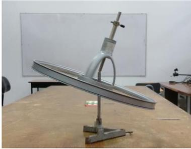
Fig. 4.67. Giróscopo gigante, suspendido sobre el centro de masa.
