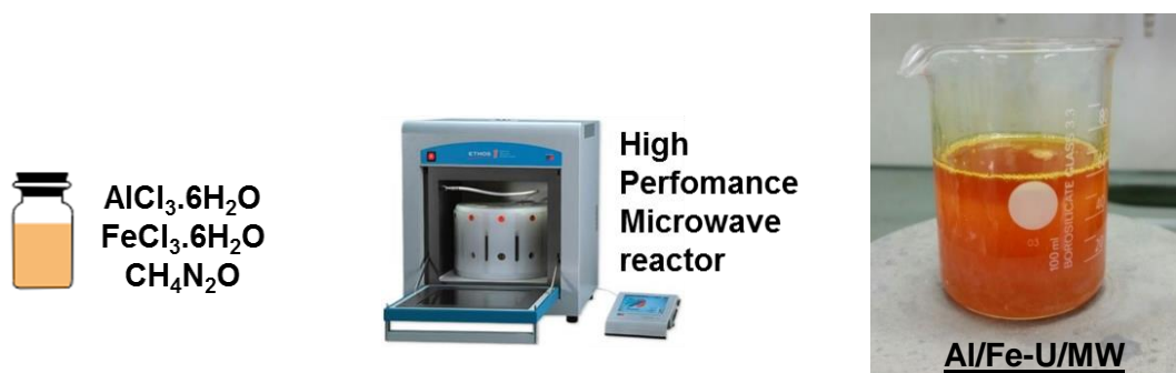
Figura 12. Preparación de disolución intercalante en medio concentrado mediante Hidrólisis in-situ vía descomposición de urea asistida por microondas (Al/Fe-U/MW)
