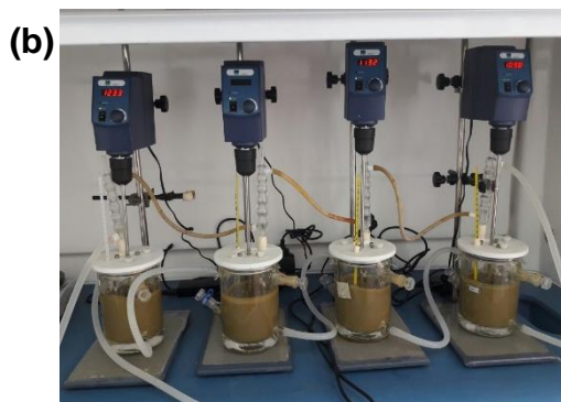
Figura 18. Procedimiento de intercalación/pilarización a escala banco (1,4 kg): (a) adición de arcilla, (b) periodo de modificación de arcilla, (c) lavado del material intercalado, (d) secado, tamizado y calcinado del material
