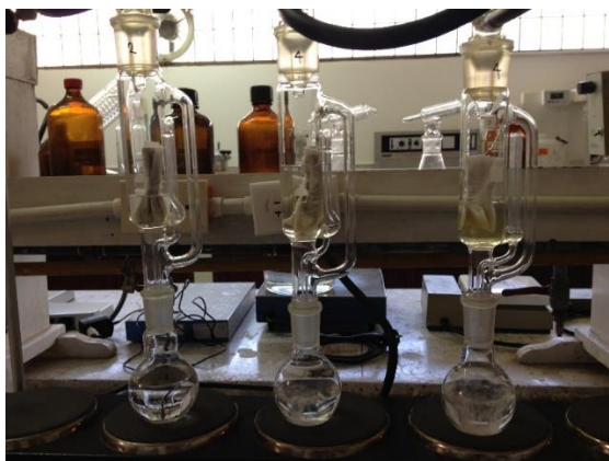
Figura 12. Montaje de extracción Soxhlet para semillas de Annona muricata .
