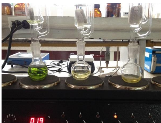
Figura 14. Montaje Soxhlet: hojas, cáscara y semillas.
