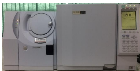
Figura 13. Cromatógrafo de Gases-Masas Shimadzu GC-MS QP2010.
