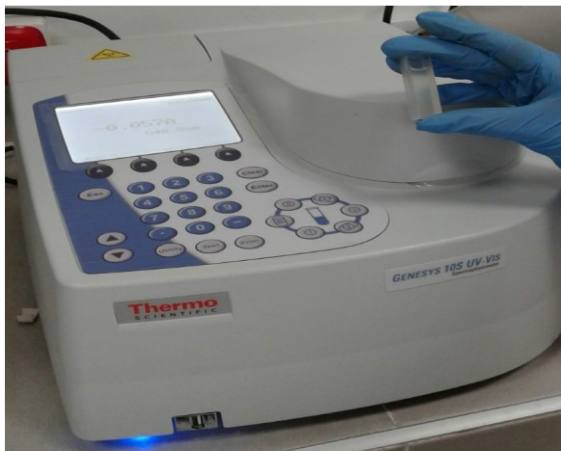
Figura 3. Medición de la muestra en el espectrofotómetro.
