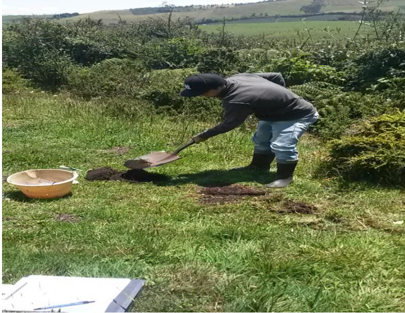
Figura 8 Toma de muestras de suelo
