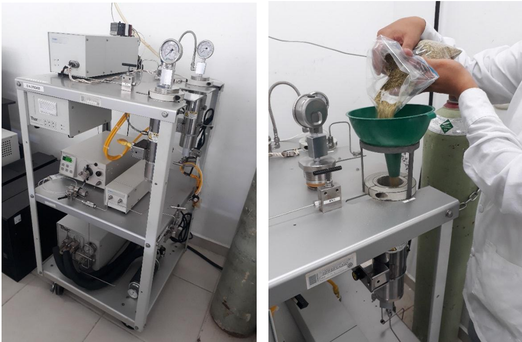
Figura 7. Proceso de obtención de aceite esencial de manzanilla (Matricaria chamomilla L.) mediante tecnología de fluidos supercríticos (SFE).
