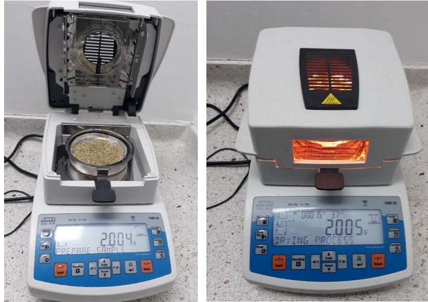
Figura 5. Determinación de humedad de manzanilla ( Matricaria chamomilla L.) en balanza gravimétrica.
