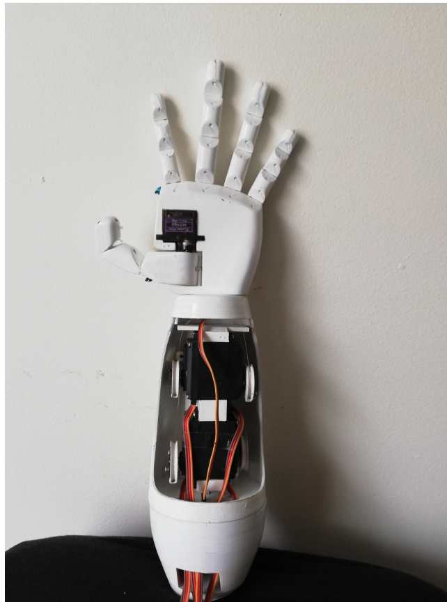
Figura 18. Brazo robótico impreso en 3D y completamente armado.
