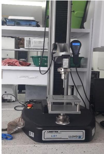
**Imagen 15. Determinación de firmeza en pimienta.**
