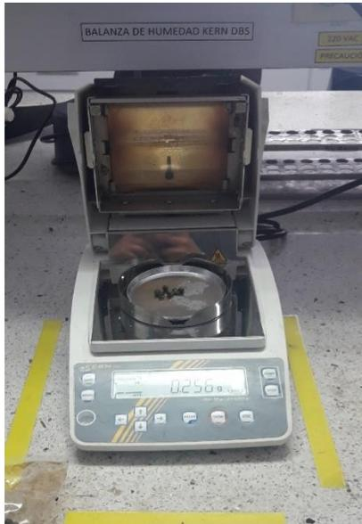
**Imagen 18. Determinación de humedad en pimienta.**
