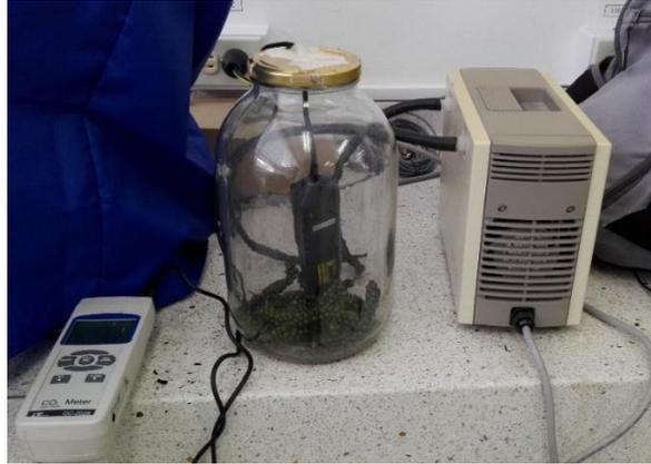
**Imagen 7. Determinación de Respiración en pimienta.**
