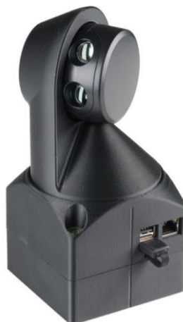
Figura 11. Scanse Sweep, sensor de escaneo laser.
