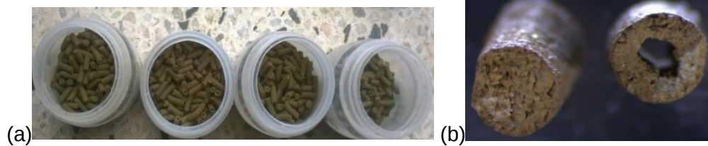
Figura 30. Conformados por extrusión: (a) antes de la calcinación y (b) después de la calcinación
