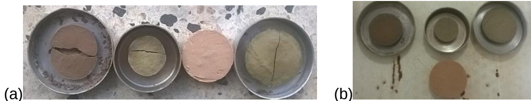
Figura 15. Contracción arcillas de partida (aglomerantes): (a) Secado rápido, (b) Secado progresivo.
