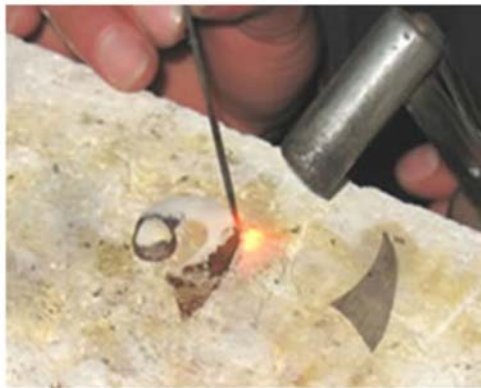
Foto 136: unión de piezas por soldadura
