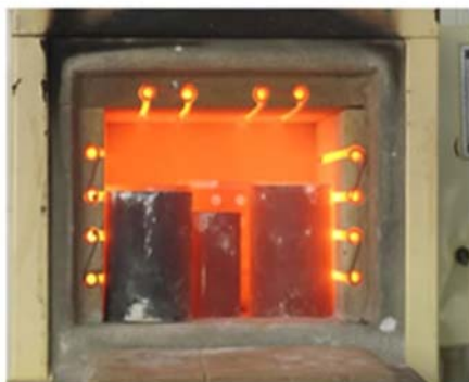
Foto 143: Moldes dentro del Horno de vaceado
