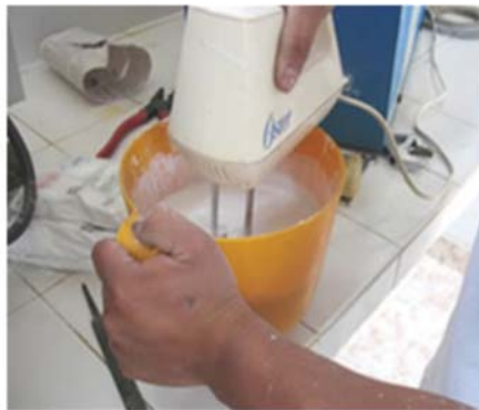
Foto 141: yeso mezclado con batidora d. Preparación del Yeso para Cásting
