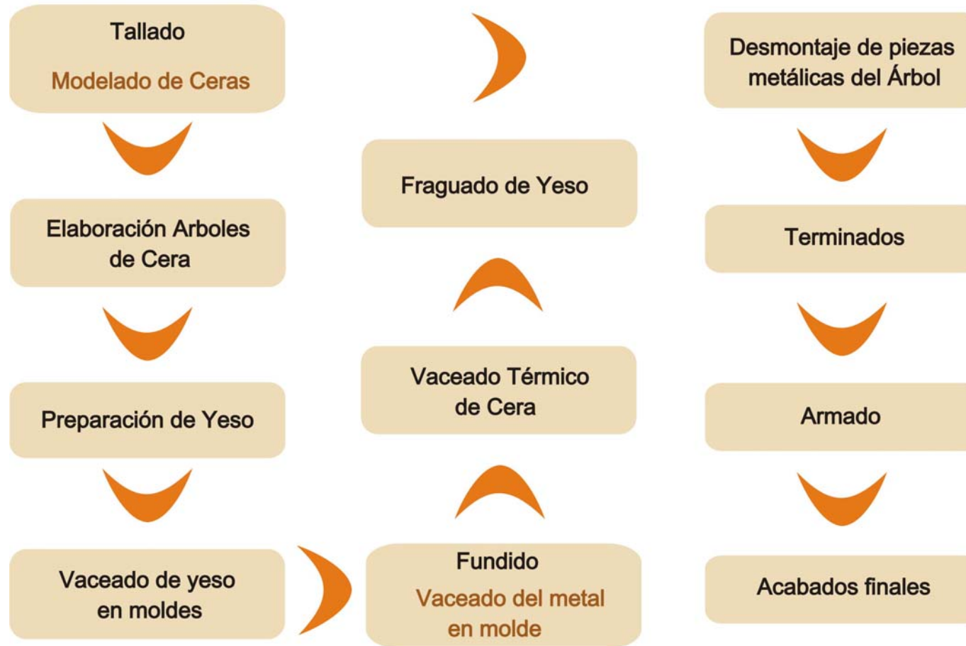
Cuadro No 29: diagrama de Proceso por casting en el taller
