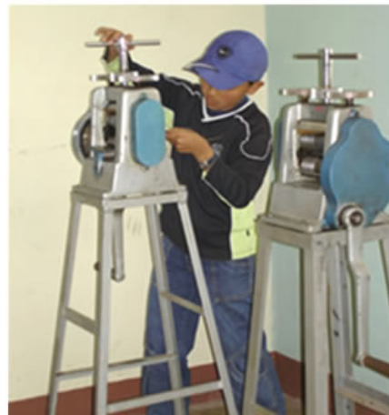
Foto No 133: Niño artesano utilizando el laminador
