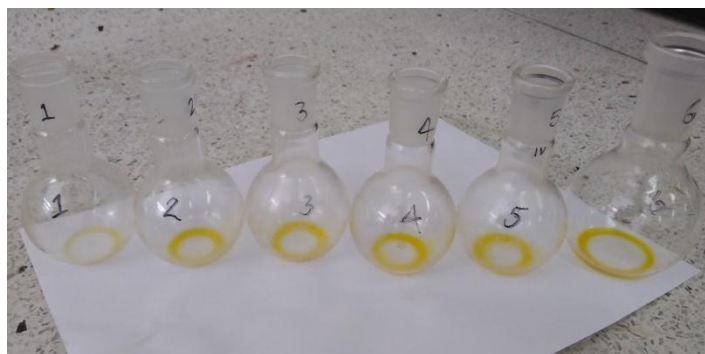
Imagen 29. Aumento en el contenido de aceite en balones con respecto al tiempo de fritura.
