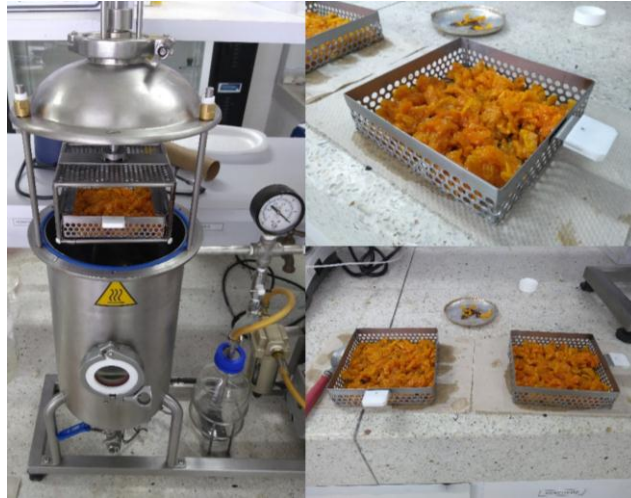
Imagen 18. Compartimentos o canastillas para muestra del equipo de fritura al vacío.
