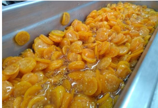
Imagen 25. Baño ultrasónico en operación de deshidratación osmótica con exceso de muestra de uchuva.
