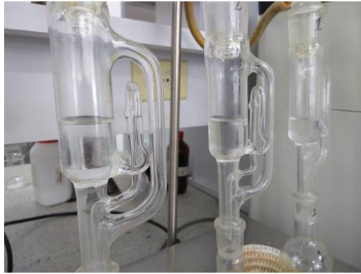
Imagen 21 Recuperación de solvente con el equipo Soxhlet.
