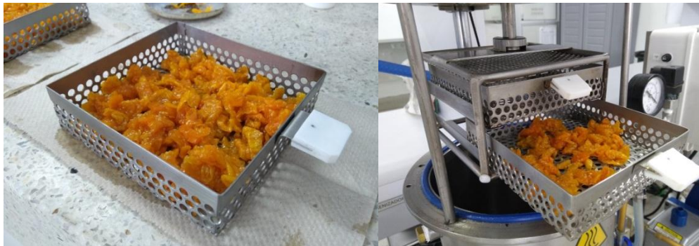
Imagen 17. Muestra de uchuva osmodeshidratada en canastilla previa a proceso de fritura al vacío.
