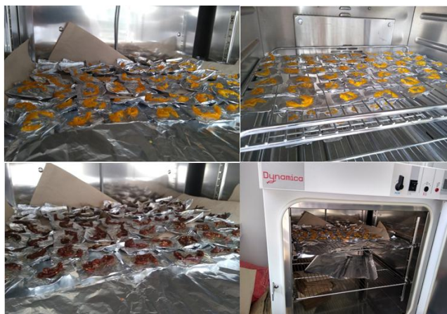
Imagen 7. Determinación de humedad de muestras por medio de calentamiento en horno
