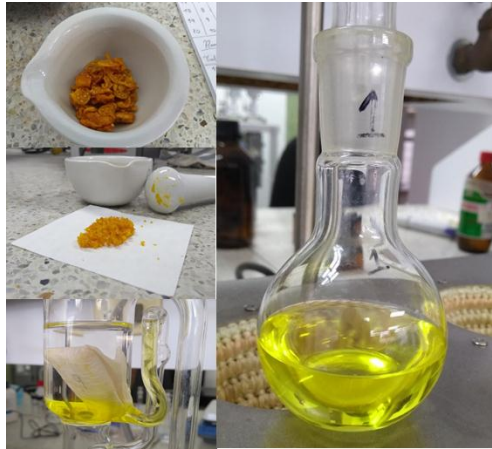
Imagen 22. Preparación y montaje para extracción de aceite de snack de uchuva.
