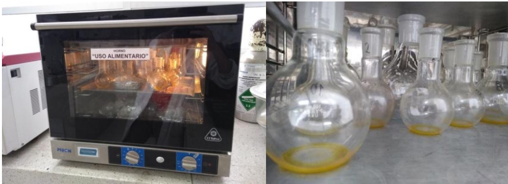
Imagen 20. Horno grado alimentario usado en el secado de balones con aceite extraído.
