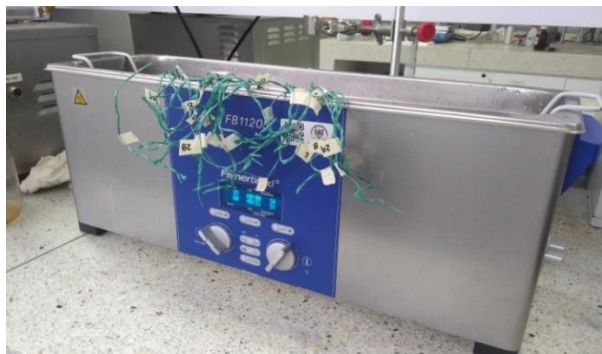
Imagen 14. Equipo de ultrasonido en proceso de osmodeshidratación para muestras de pérdida de peso.
