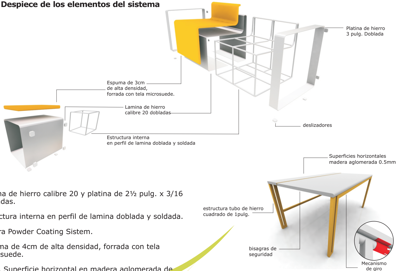
Gráfico 24: Despiece de los elementos del sistema
