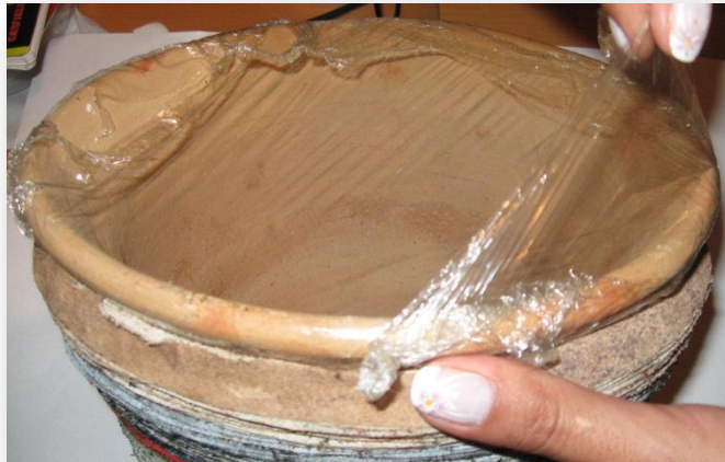
54. Paso 4: desmolde y volteado. Proceso productivo contenedor trulakuna
