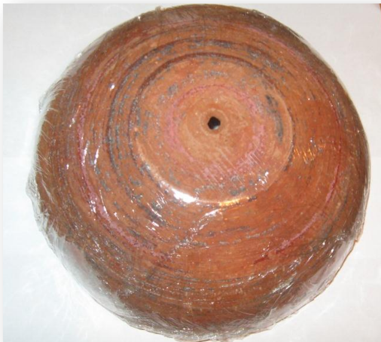
52. Paso 2: Molde cubierto con plástico osmótico. Proceso productivo contenedor trulakuna
