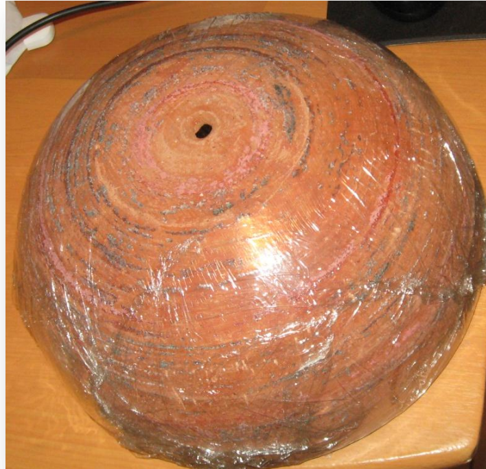
66. Paso 2: Molde cubierto con plástico osmótico. Proceso productivo contenedor niichu
