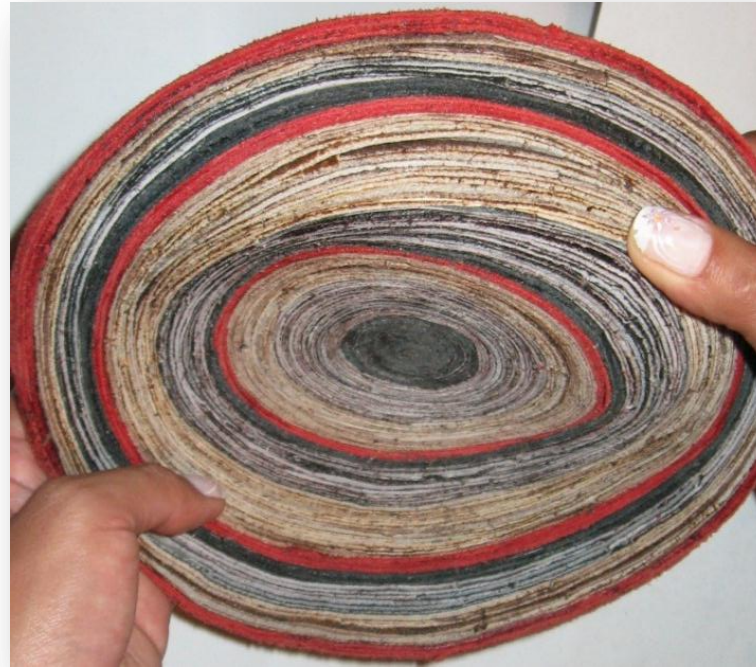
68. Paso 4: desmolde y volteado. Proceso productivo contenedor niichu
