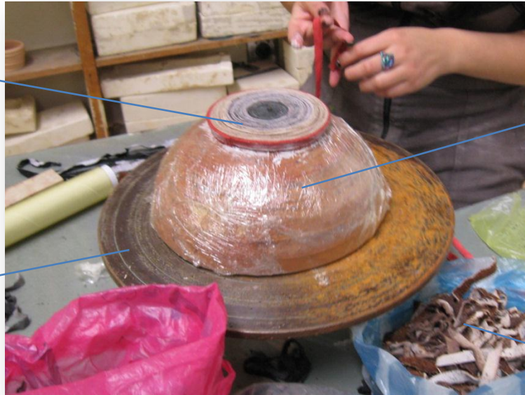
53. Paso 3: Producción con torno. Proceso productivo contenedor trulakuna
