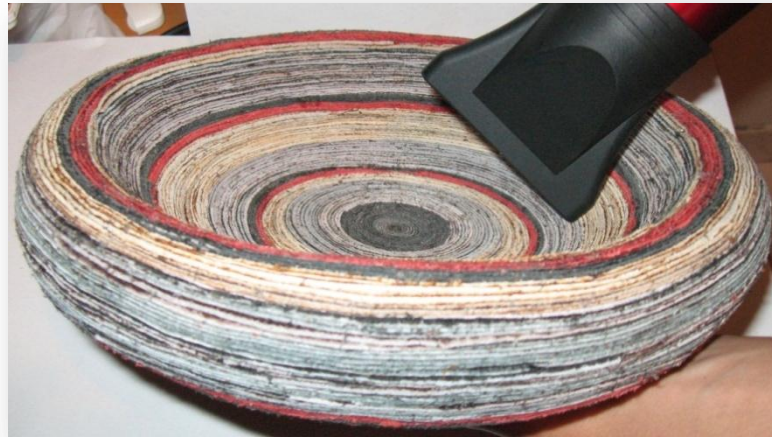
72. Paso 8: proceso de secado. Proceso productivo contenedor niichu
