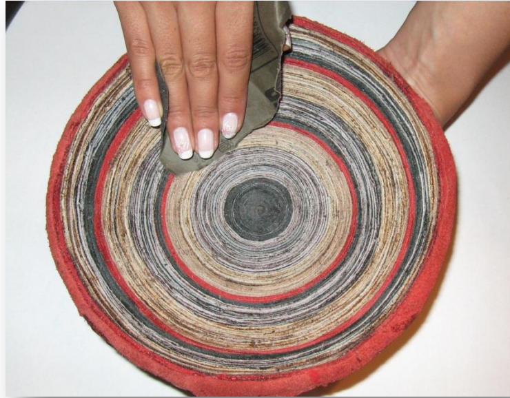
55. Paso 5: terminado con lija. Proceso productivo contenedor trulakuna
