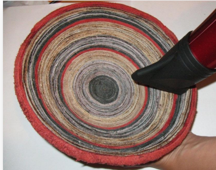
57. Paso 7: proceso de secado. Proceso productivo contenedor trulakuna
