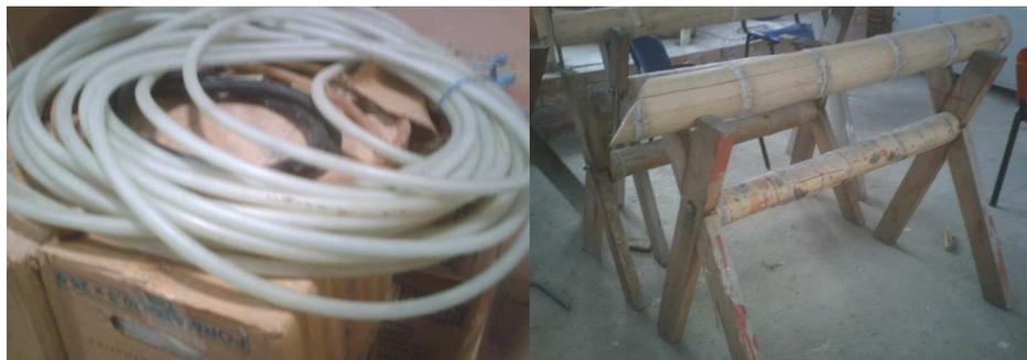
**Manguera Plástica.** Es el instrumento de toma de niveles más preciso utilizado en la construcción, consiste en llenar de agua una manguera de caucho transparente y ubicar un extremo de ella en una altura que se quiera y llevar el otro extremo hasta una altura y observar el nivel del agua.
