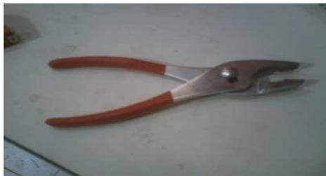
**Alicate:** Sirve para sujetar, apretar, sacar, cortar; es una herramienta metálica muy útil utilizada en el campo de la construcción.
