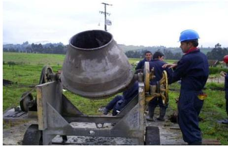
**Trompo.** Se la utilizo para revolver mezcla de cemento, arena, triturado, y agua en la fundición de zapatas y columnas haciendo que las mezclas sean de mejor calidad, y de igual manera disminuir tiempo.
