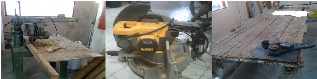
**Máquina Sierra Circular:** utilizada para hacer cortes en ángulo recto, se la utiliza para cortar tabla para hacer las formaletas de columnas de concreto, esta máquina cuenta con un banco donde se coloca la tabla que se va a cortar, un disco cortador, un brazo para graduar el ancho que quiere cortar, sistemas de guía, seguro del disco giratorio
