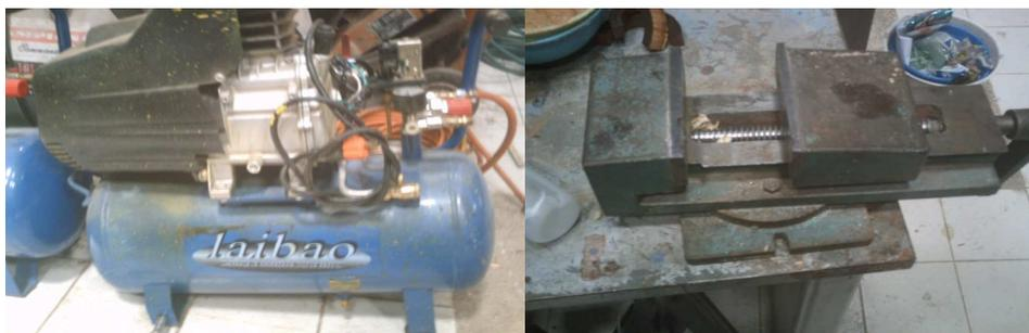
**Compresor.** Utilizado para pintar. Su sistema incluye un motor que recoge el aire del exterior y lo acumula en el interior de un tanque para luego ser expulsado por una manguera que llega hasta una pistola que contiene pintura para poder esparcirla.
