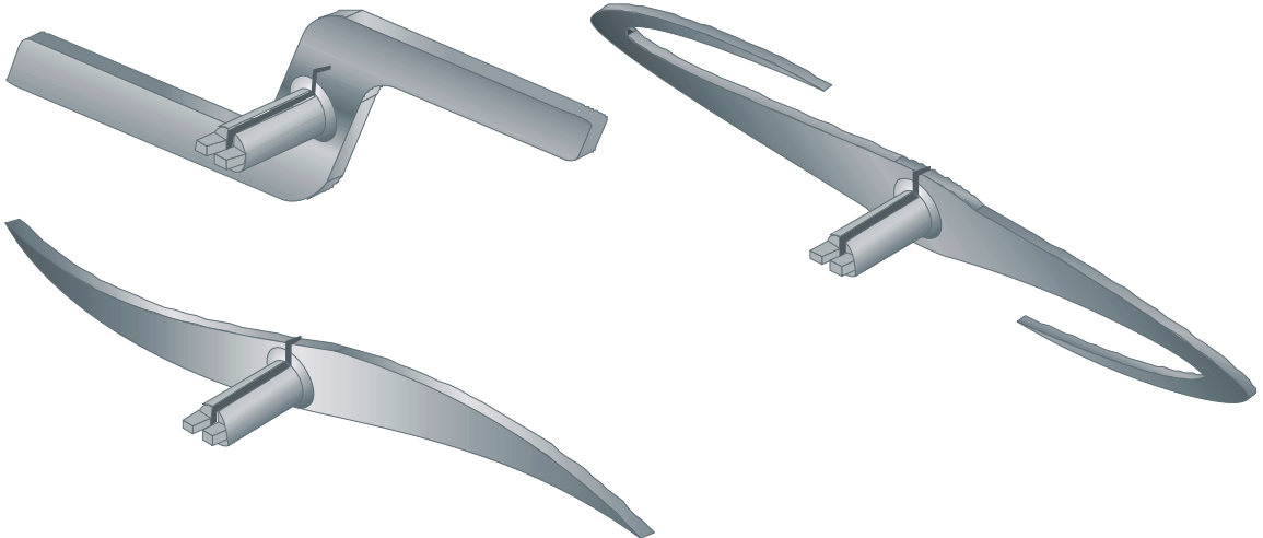
C. SISTEMA DE VOLANTES agilizan el tiempo de instalación pero presentan inconvenientes por sus dimensiones
