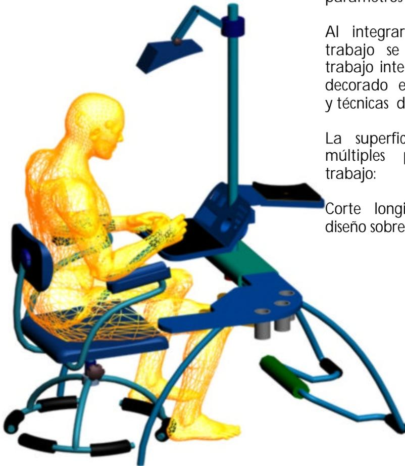
El puesto de trabajo tiene componentes funcionales apropiados que facilitan la actividad del decorado en cuanto a confort, antropometría, estabilidad y estética, logrando conformar una unidad integral de trabajo, resolviendo cada uno de los parámetros de diseño.
