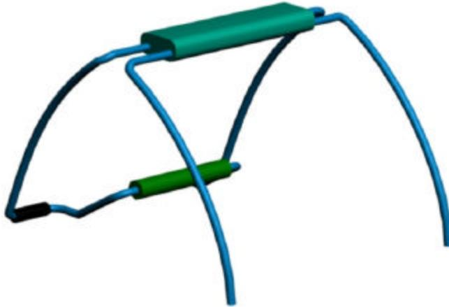
Se continúa con el proceso de diseño de la parte estructural de soporte planteada para lograr una máxima estabilidad, la estructura consta de dos patas frontales tubulares y una estructura tubular trasera a la cual se integra un apoya-pies; las piezas tubulares se acoplan insertándose en una base rectangular de perfil elíptico provista de cuatro orificios.
