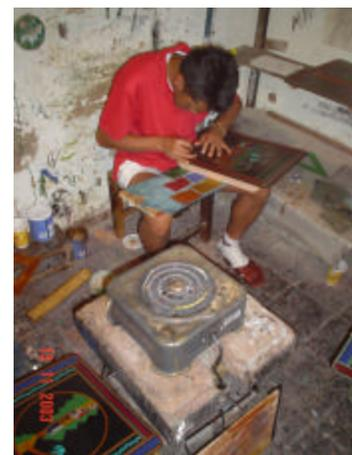
En esta etapa se utiliza un reverbero que transmite calor a la pieza para fijar el barniz después de la decoración.
