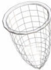
Se diseñó receptáculos de forma adecuada para la fácil extracción e intercambio sobre las superficies de trabajo, se determina que entre las superficies de trabajo existen diez receptáculos destinados a el almacenamiento de los residuos de barniz, facilitando la clasificación por color.
