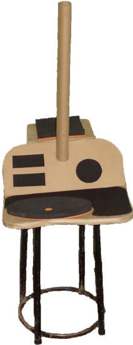
Se desarrolla una maqueta funcional montada sobre una estructura para determinar alturas y proporciones respecto de los parámetros antropométricos.
