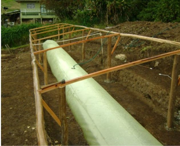
*Figura A.3.25.* Biodigestor con su compartimiento lleno de aire.
