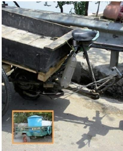
Figura A.3.6. Cisterna para transporte de lodos fecales en remolque traccionado por motocicleta. Fuente: Akvopedia (2007). [https://akvopedia.org/wiki/File:Cartage\\_systems.png](https://akvopedia.org/wiki/File:Cartage_systems.png)
