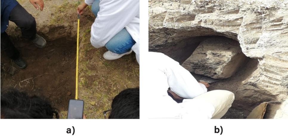
**Figura 3.9.** Toma de muestras para análisis y caracterización de suelos. (a) Excavación y toma de muestras alteradas, (b) tallado y futura extracción de una muestra inalterada de suelo por medio de un bloque.
