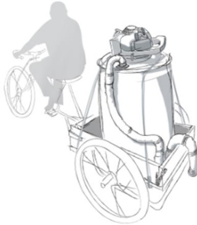
*Figura 3.27* . . Ejemplo de operación manual de eliminación de lodos (RTI International, 2011).
