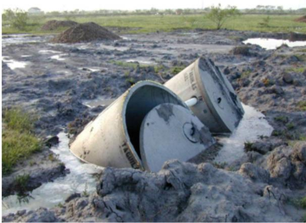
**Figura 3.24.** Colapso de un tanque séptico debido a las fuerzas de flotabilidad. Fuente: (Comunicación personal: Lindbo, 2011).
