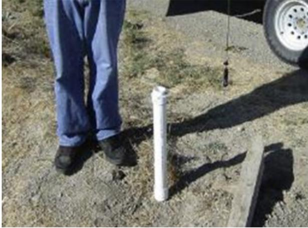
Figura 3.20. . Pozo de monitoreo de aguas subterráneas poco profundas.
