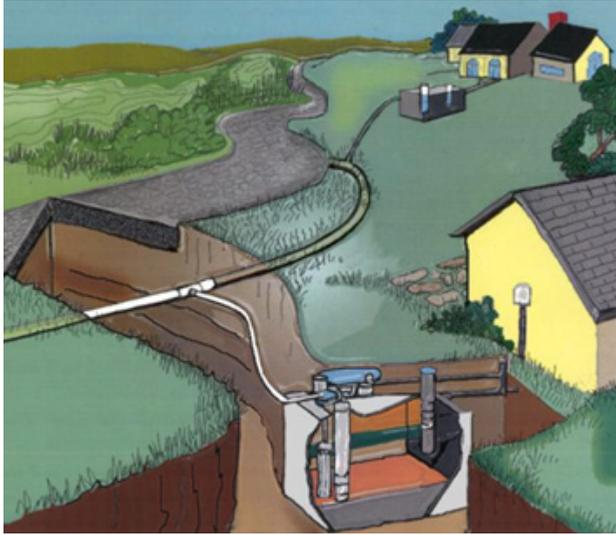
*Figura 4.21.* Esquema del sistema de bombeo de efluentes del tanque séptico. (Fuente: Jones et al., 2001, p. 6)
