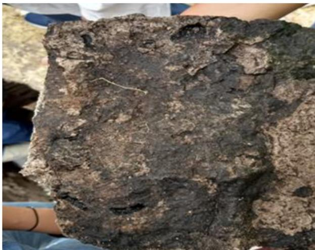
*Figura 3.6.* . Bloque de suelo tomado como muestra inalterada, el material contiene principalmente arcillas y limos y pequeñas porciones de materia orgánica, de la muestra se suelo se obtendrán informaciones para planificar el SDMAR.
