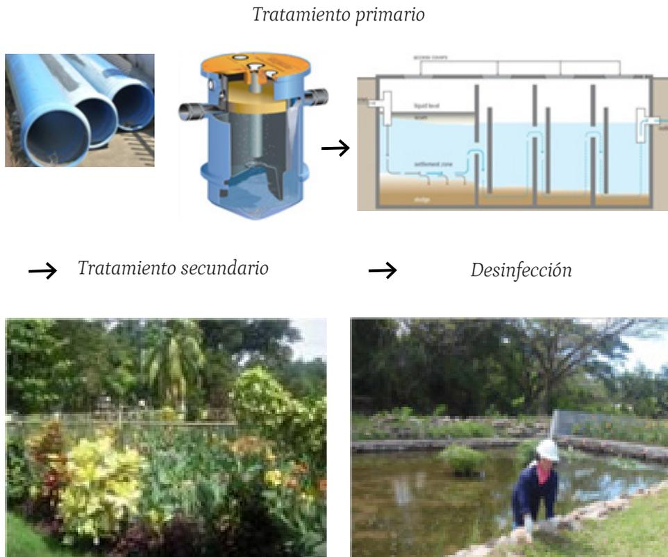
**Figura 4.2.** Sistema de aguas residuales para una escuela típica, incluyendo (de izquierda a derecha): tubería de alcantarillado; trampa de grasas; reactor anaerobio con deflectores, para tratamiento primario; humedales construidos, para tratamiento secundario y lagunas de pulimento, para desinfección (Fuente: Adaptado de Tilley et al., 2014, p. 106; Thermaco, Inc, 2013).
