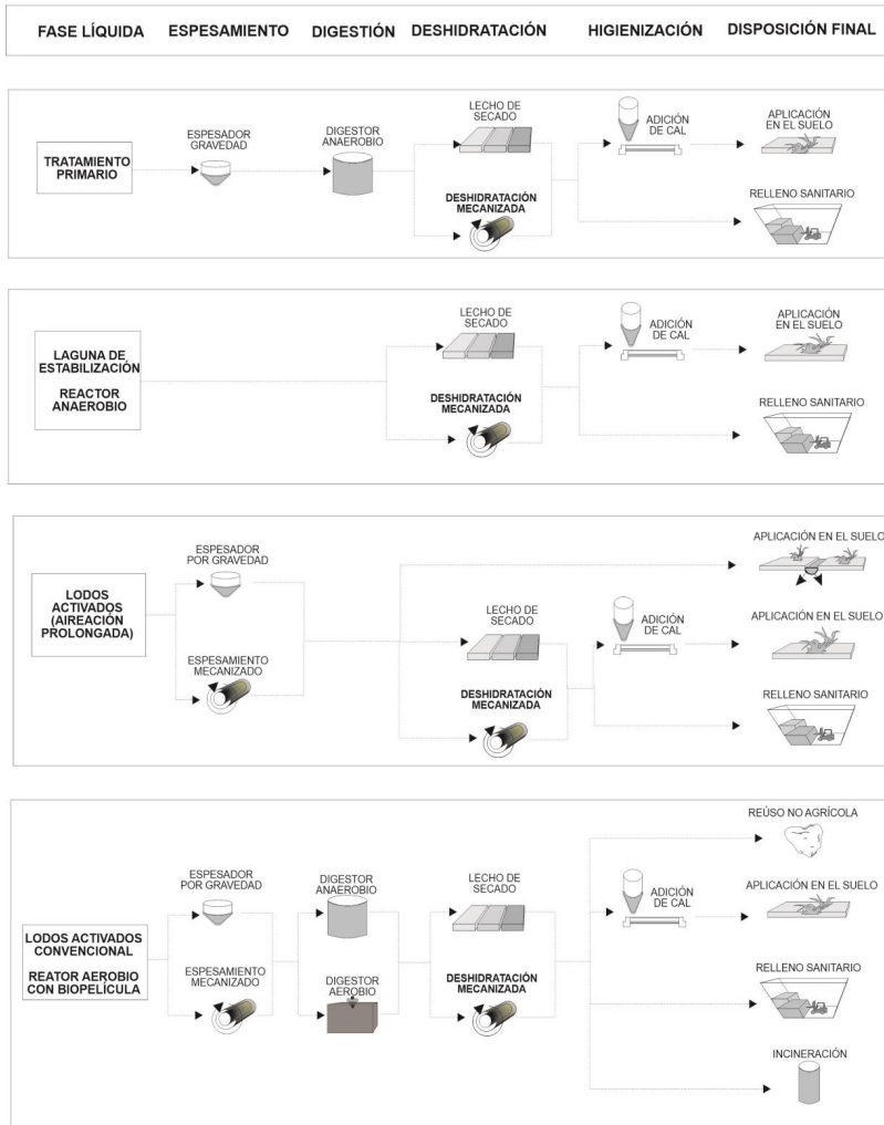
Fig. 2.7. Diagramas de flujo usuales del tratamiento y disposición del lodo (representación esquemática de procesos frecuentemente utilizados; ciertas etapas pueden ser opcionales; en cada etapa, hay diversas variantes del proceso; ver Cuadro 2.5)
