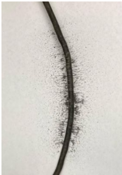
Fig. 8.21. Campo magnético rotacional alrededor del conducto de soldador de arco. Fuente: fotografía del autor.
