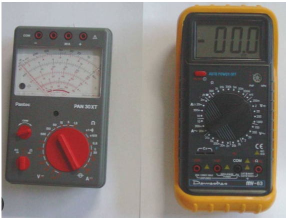
Fig. 6.41. Multímetros: análogo (años 80/90) y digital (año 2000). Fuente: ETSIT- UPM (2010).
