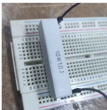
Figura 5.1.1: Montaje resistencia de potencia
