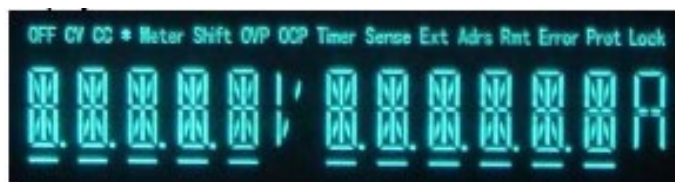
Figura 4.1.18: indicadores pantalla del panel frontal, extraído manual de usuario Fuente de alimentación CC lineal PWS2721
