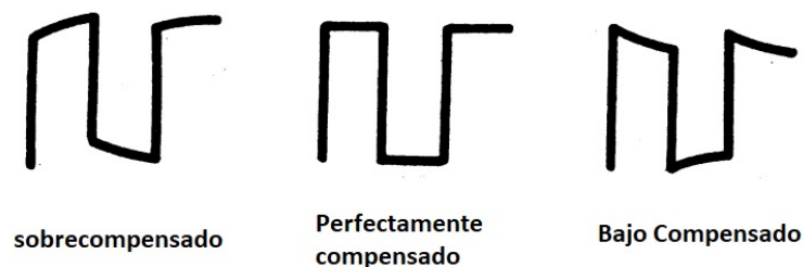
Figura 4.1.7: formas de onda, extraído manual de usuario osciloscopio SDS2000X
