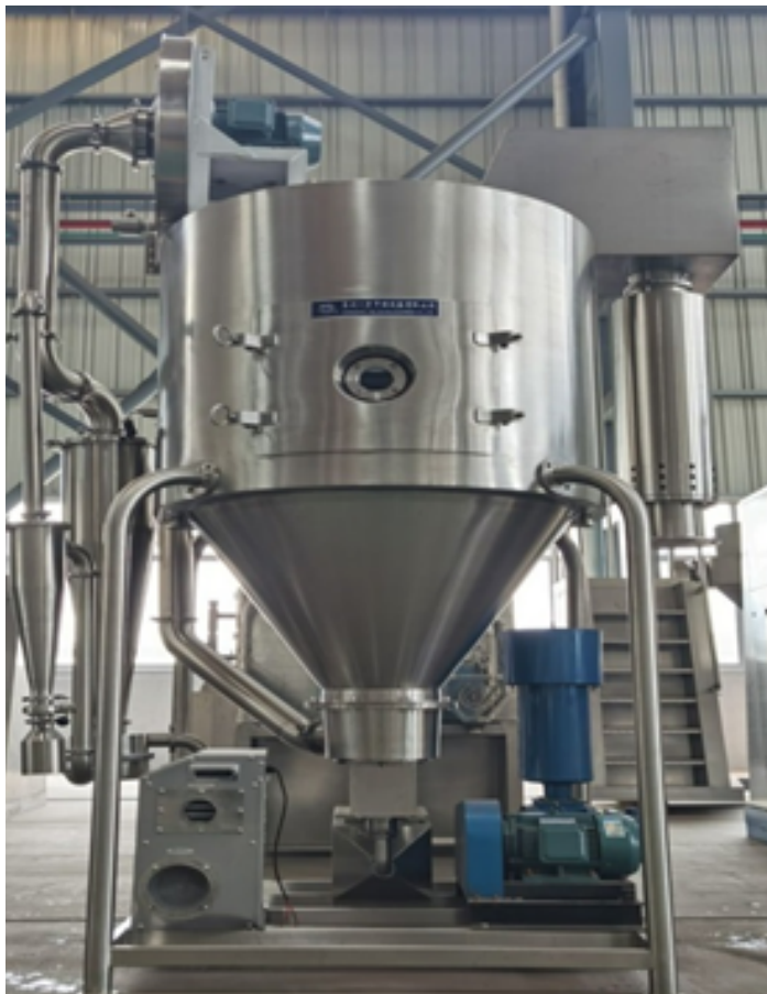
Figura 11 Secador por aspersión con sistema de centrifugación Fuente: Changzhou Yibu Drying Equipment Co., Ltd. (2022)
