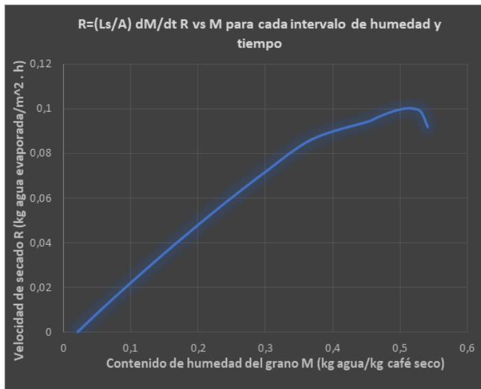
Figura 61 Distribución de la velocidad de secado R en función del contenido de humedad del grano M. R representa los kg de agua evaporada por unidad de área (m 2 ) y tiempo (h). Secador con concentrador solar parabólico
