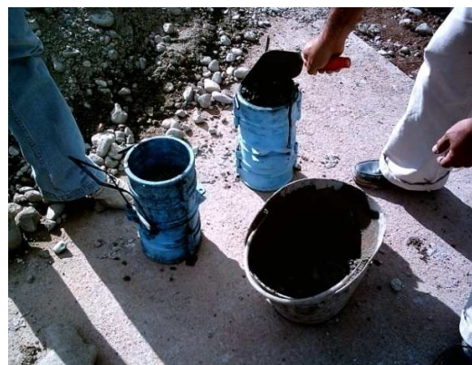
Fig. 85 Toma de muestra para ensayos de resistencia
