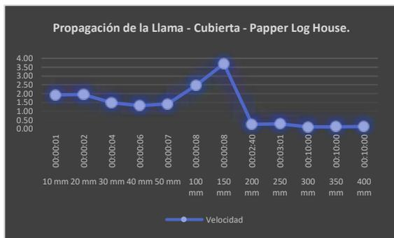
Ilustración 30. Papper Log House - Propagación de Llama: Cubierta.
