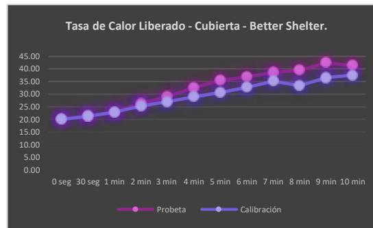
Ilustración 36. Better Shelter - Tasa de Calor Liberado: Cubierta.
