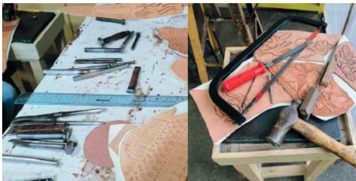
Fotografía 70. A la izquierda se observa cómo las herramientas deben colocarse en una mesa aparte, ya que en el yunque tienen a caerse cuando se las coloca en los extremos y a la derecha se observa cómo el espacio del yunque es reducido para colocar otros elementos, tomada por los autores (2021)
