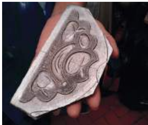
Fotografía 14. Molde de hierro para troquelado, por los autores (2021)
