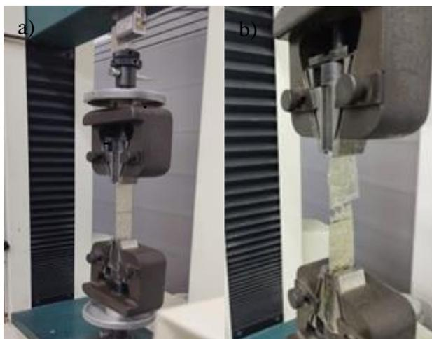
**Figura 12. Montaje prueba mecánica Escuela de Ingeniería de la Universidad del Valle b) Probeta rota**
