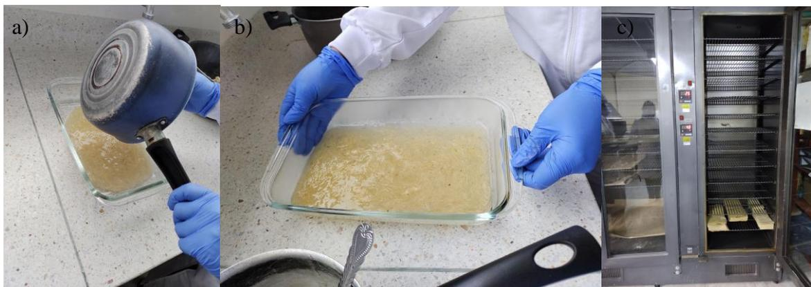
**Figura 5. a) y b) Preparación de la mezcla c) Secado de las láminas en horno**
