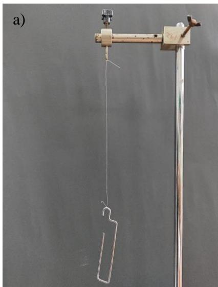
**Figura 4. a) Montaje prueba mecánica a la fibra de fique**
