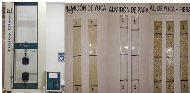
**Figura 6. a) Montaje prueba mecánica b) Probetas de películas**
