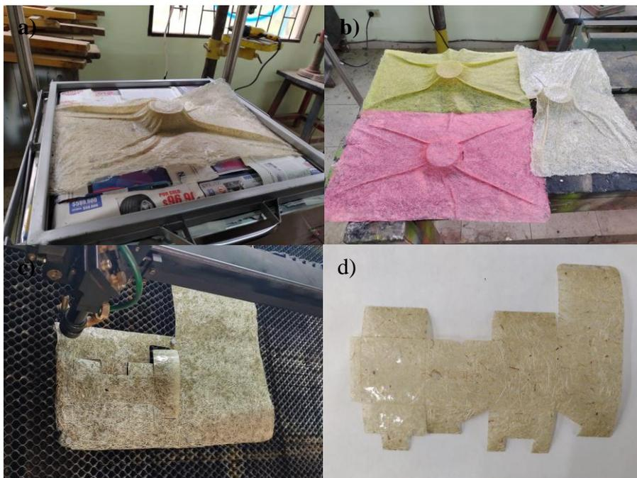
**Figura 21. a) y b) Pruebas de termoformado en APF Y AYF c) y d) Prueba con corte laser en AYF**
