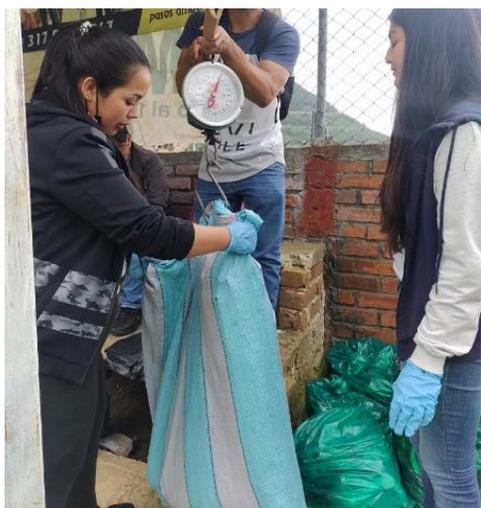
**Figura 6.** Pesaje de residuos obtenidos mediante técnica de cuarteo
