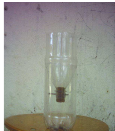
Montaje para Decantación Construido por Estudiantes
