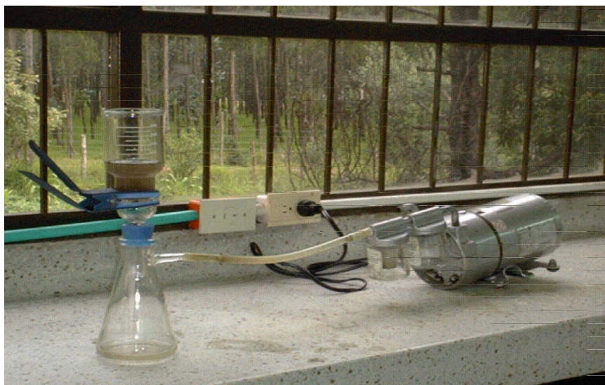
Figura 6. Filtración al vacío con el equipo de filtración Millipore
