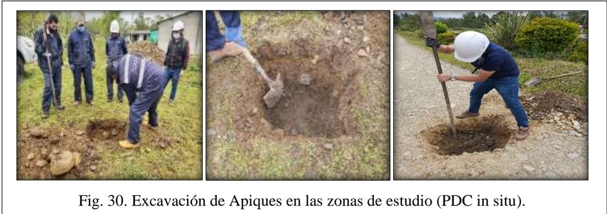
Fig. 30. Excavación de Apiques en las zonas de estudio (PDC in situ).
