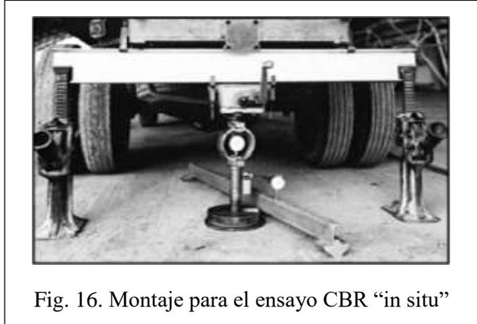
Fig. 16. Montaje para el ensayo CBR "in situ"
