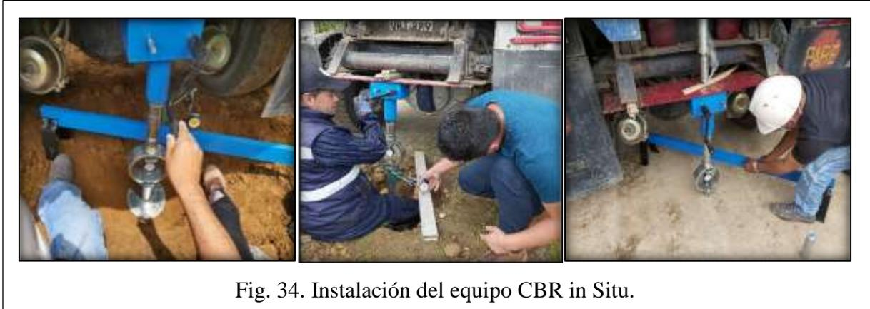
Fig. 34. Instalación del equipo CBR in Situ.
