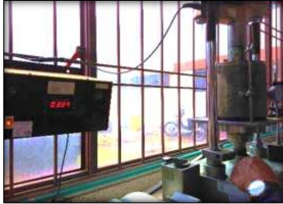
Fig. 38. Lecturas de penetraciones (CBR inalterado)
