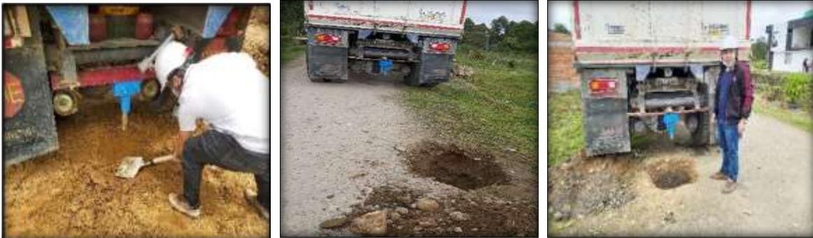
Fig. 33. Excavación de Apiques en las zonas de estudio (CBR in situ)
