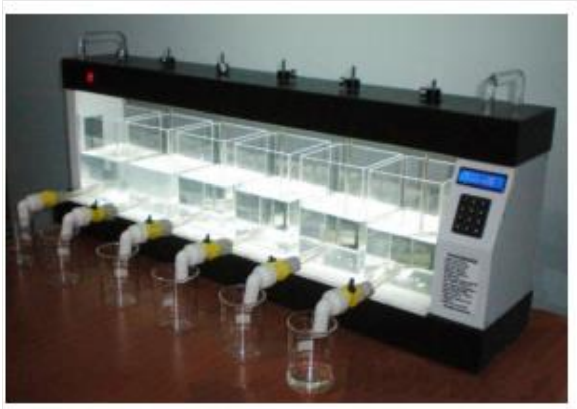
Figura 10. Forma y medidas de las Jarras y paletas del equipo de Prueba de Jarras MD. Y-FL6 del laboratorio de hidráulica y saneamiento básico de la Universidad de Nariño, utilizado en esta investigación.
