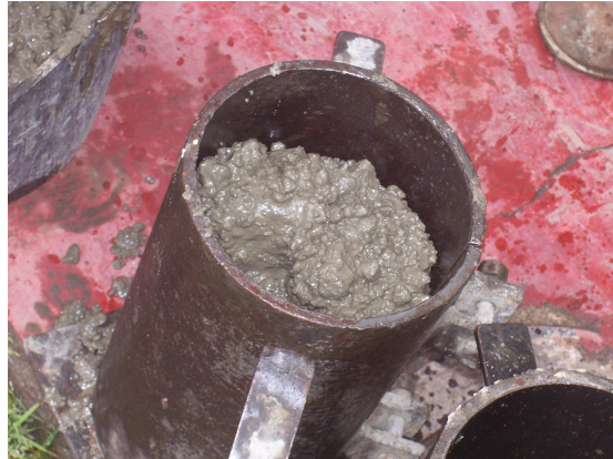
Fotografía No 115. Toma de muestras de concreto
