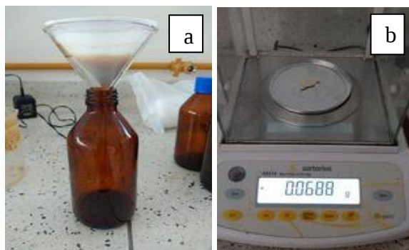
Figura 6. Determinación de la biomasa. a) Filtración de la biomasa. b) Peso de la biomasa seca. ( Fuente: Esta investigación)
