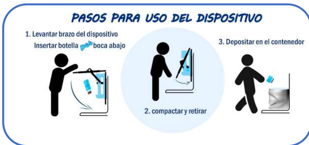
IMAGEN 50. PASOS PARA USO DEL DISPOSITIVO COMPACTADOR DE PET
