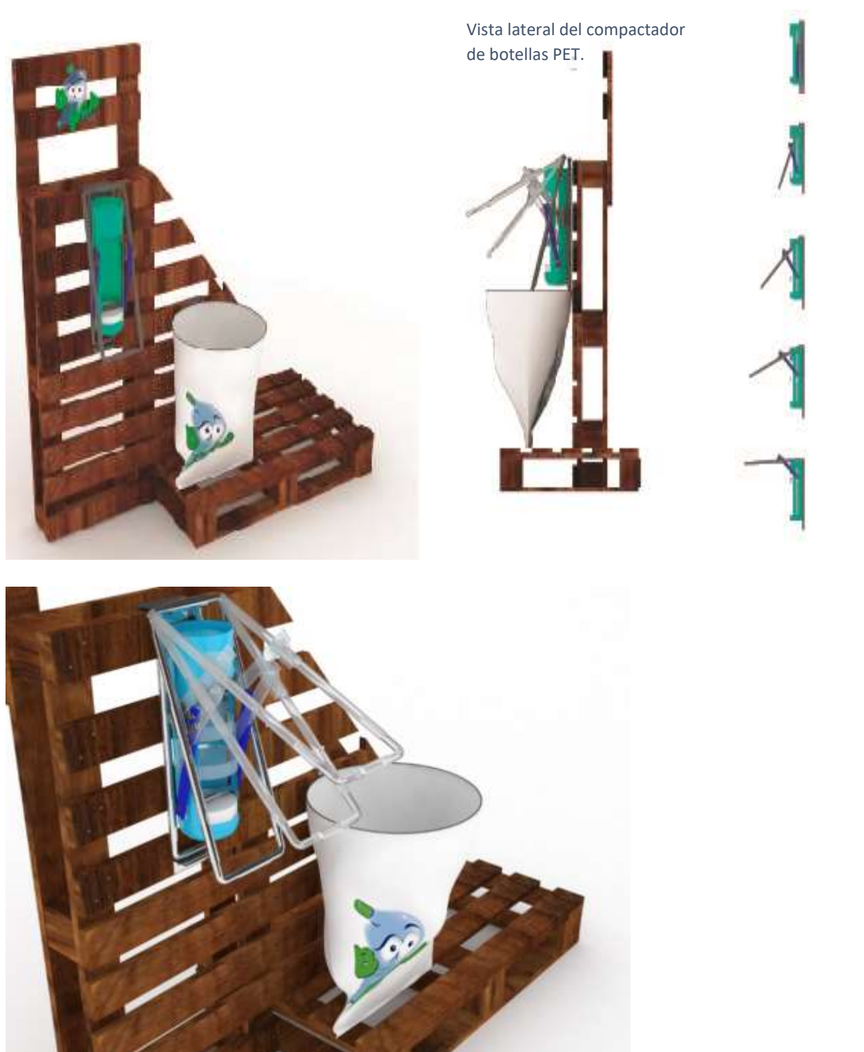
IMAGEN 49. RENDER INSTALACIÓN DEL DISPOSITIVO COMPACTADOR
