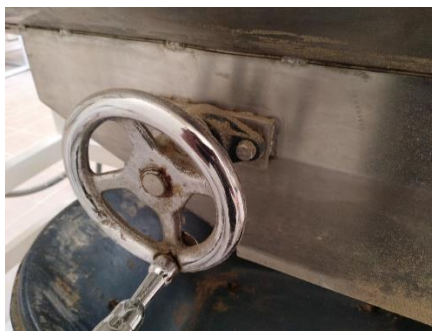
Figura 9. Corrosión en algunas partes de maquinaria - Fuente: Autor
