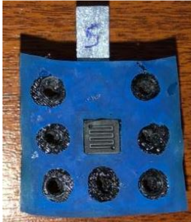
Figura 8. Placa terminal, colector de corriente, sello (azul) y placa bipolar con canal en serpentin.
