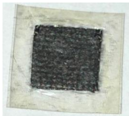
Figura 5. Ensamble membrana-electrodos obtenido según el procedimiento descrito en el texto. Fuente: Esta investigación.
