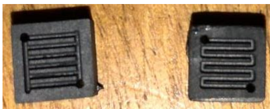
Figura 7. Geometría de canales de alimentación sobre las placas bipolares. Izquierda: Configuración en paralelo; Derecha: Configuración en serpentín. Fuente: Esta investigación.
