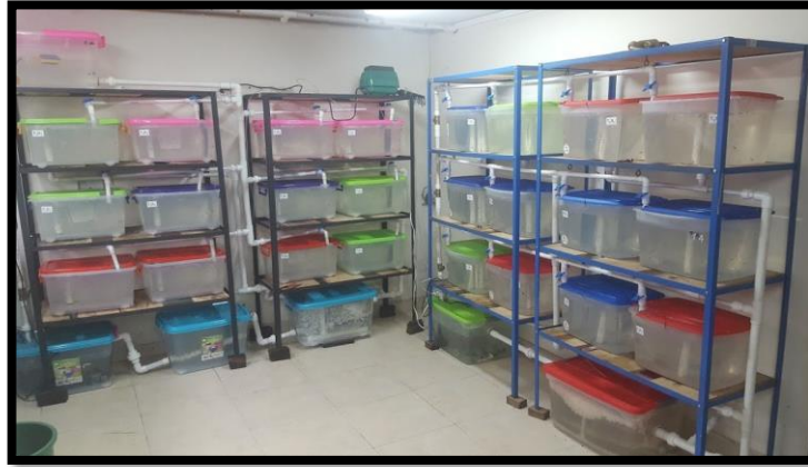
Figura 3. Sistemas de Recirculación Acuícola (SRA)
