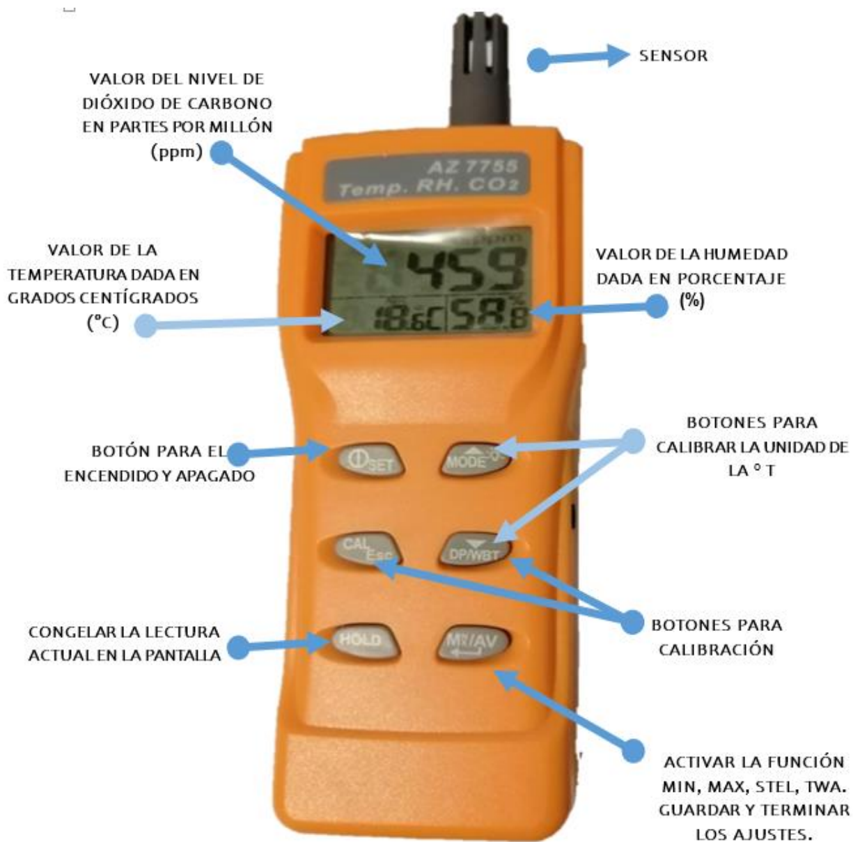
Imagen 7. Partes del medidor portátil de CO 2 /modelo AZ 7755
