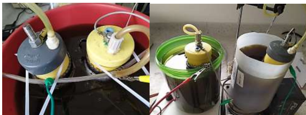
Figura 70. Disposicion de las CFIS en uno y en dos recipientes.
