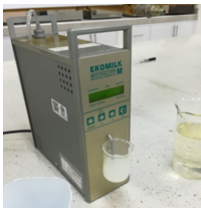
Figura 4. Equipo Ekomilk para determinación de parámetros físico-químicos en leche.
