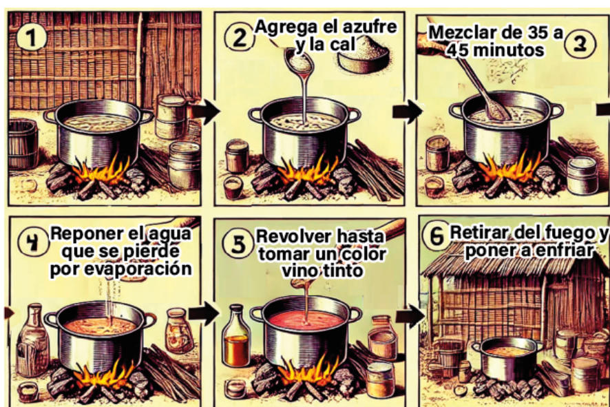
Figura 2. Diagrama de flujo para la elaboración de Caldo Sulfocálcico
